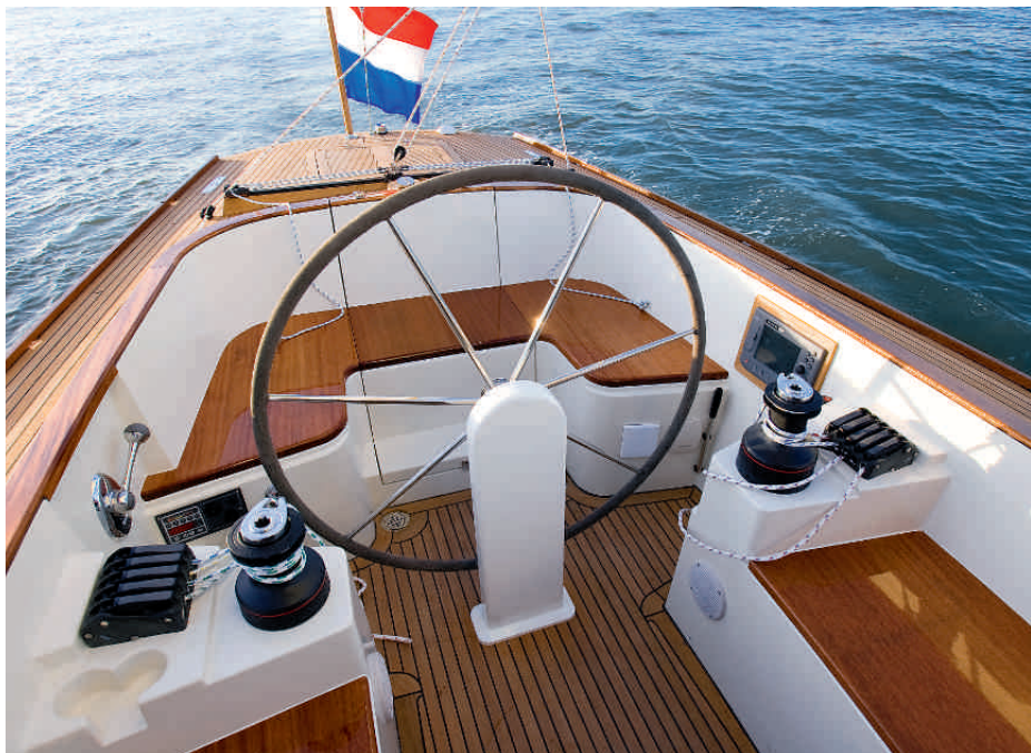
Praktisch. Die Schoten und Fallen laufen ausnahmslos auf die Podeste im Cockpit
