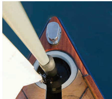
Versenkt. Die Rollanlage für das Vorsegel ist im Bug eingelassen
