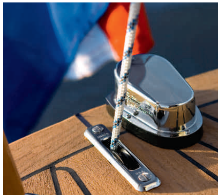
Versteckt. Alle Funktionen sind unter Deck geführt, so auch das Achterstag
