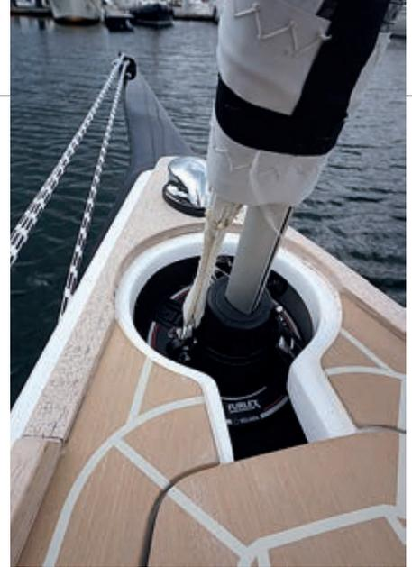
Hoher Fertigungsanspruch: Unter-Deck-Rollanlage.
