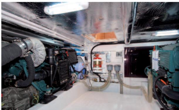
Der aufgeräumte Motorraum unter dem Salonboden ist gut gedämmt und verfügt über Zugänge vorne und achtern. Die Seewasserfilter sind über die achtere Luke gut erreichbar.
