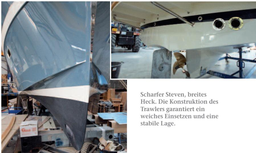
Scharfer Steven, breites Heck. Die Konstruktion des Trawlers garantiert ein weiches Einsetzen und eine stabile Lage.
