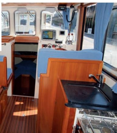
Feuerstelle: Arbeitsflächen aus Corean, Herd mit Backofen, zahlreiche Schubladen und Fächer, Belüftungsschlitze in den Schranktüren, der Kühlschrank unterm Fahrersitz: Die Pantry bietet Komfort und überzeugt auch im Detail.
