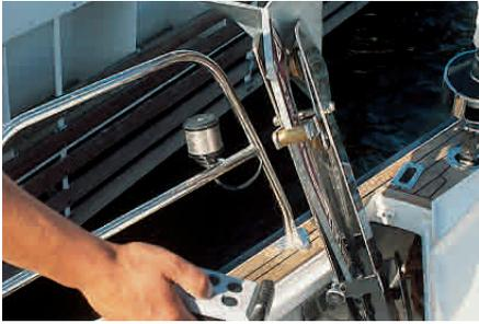
**Versenkt:** Der Anker mit Galgen und Rolle wird elektrisch in den Bugkasten versenkt
