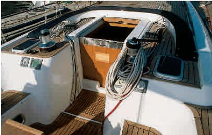
**Durchdacht:** Die Fallen verschwinden unter einer Grätting. Das Schott ist versenkbar
