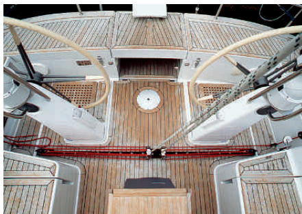
Doppelte Räder, tiefer Traveller: Effizienz, Kontrolle und einfacher Durchgang
