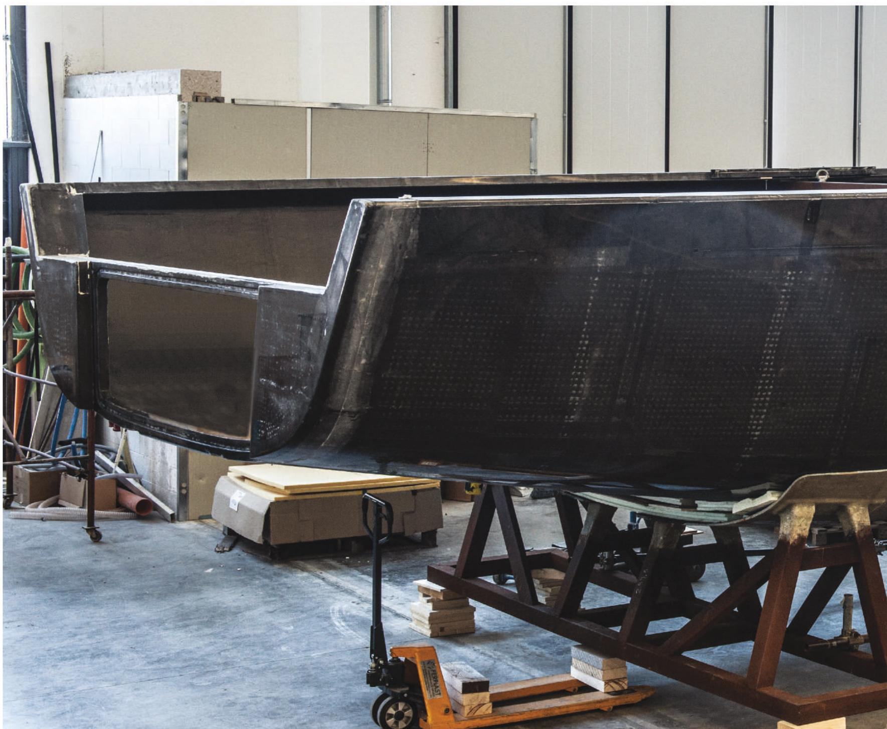
Per questo importante progetto sono stati scelti materiali e tecniche di costruzione di primissimo livello. Caratteristica unica del Grand Soleil 48 è che l'armatore può scegliere tra tre diverse tipologie di costruzione: epossidica, carbonio ed epoxy vinilestere. Tutte le paratie sono in composito.
