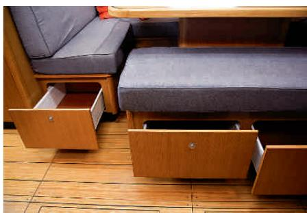
**Nüchtern und funktionell. Erst auf den zweiten Blick zeigt sich der Innenausbau von seiner angenehmen, wohnlichen Seite. Der Ausbau im Testschiff besteht aus kanadischer Eiche, im Standard wird Mahagoni verbaut. Die tollen Holzarbeiten ziehen sich bis in die Nasszelle durch. Besonders gelungen ist die Stauraumgestaltung. Schubladen ersetzen die sonst üblichen Toploader**
