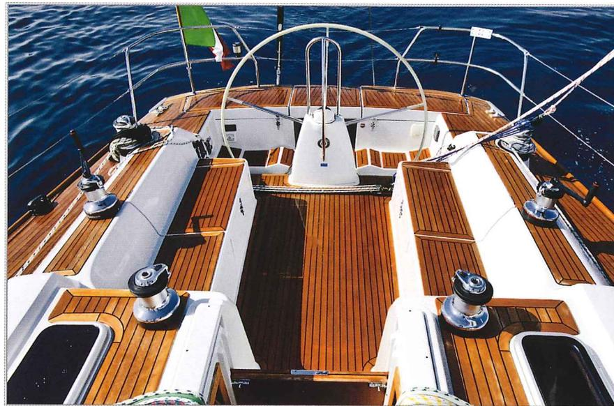
Cockpits ermöglicht Fahrten- wie auch Regattasegeln. Die unter Deck geführten Fallen, die Sprayhood-Garage und der kurze Aufbau bestimmen ein aufgeräumtes Deck ohne Hindernisse für die Crew.
